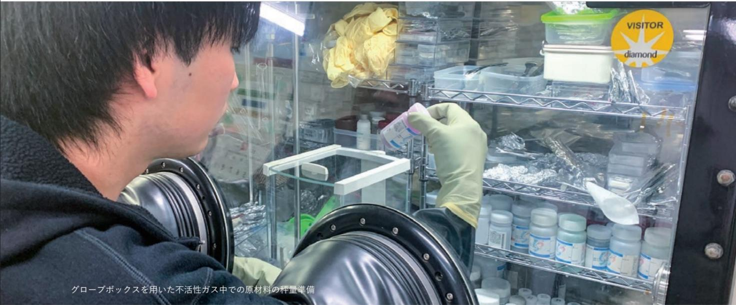
グローブボックスを用いた不活性ガス中での原材料の秤量準備
